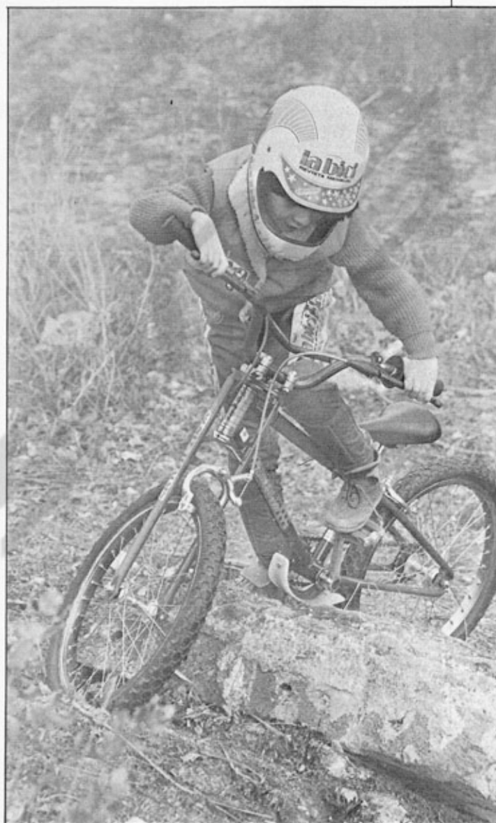
La altura suelo-patín protector es correcta. No podemos decir lo mismo del posicionamiento de las manetas.
